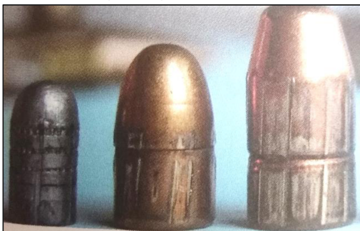
Obrázek č. 3.11 – detail stop na povrchu střel [14]
