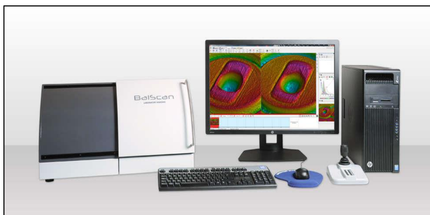
Obrázek č. 3.19 – ukázka balistického identifikačního systému BalScan [22]
