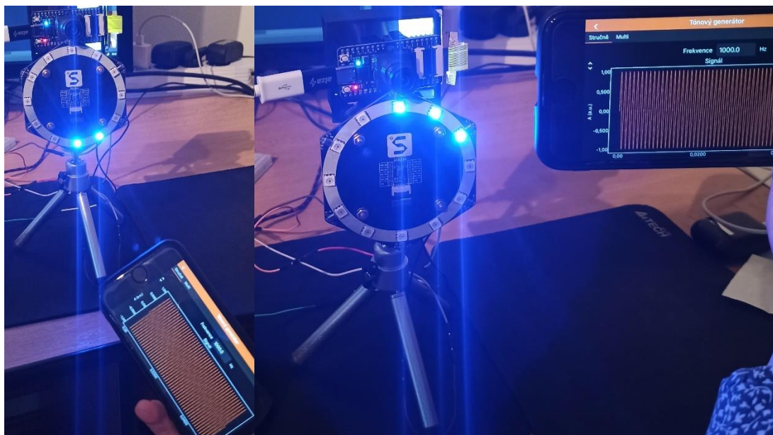
Obrázek 46 Ověřování funkčnosti rozpoznání směru zdroje akustického signálu a) signál zespodu b) signál z vrchu
