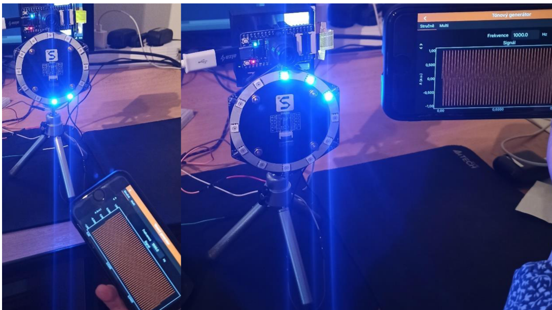
Obrázek 46 Ověřování funkčnosti rozpoznání směru zdroje akustického signálu a) signál zesponu b) signál z vrchu
