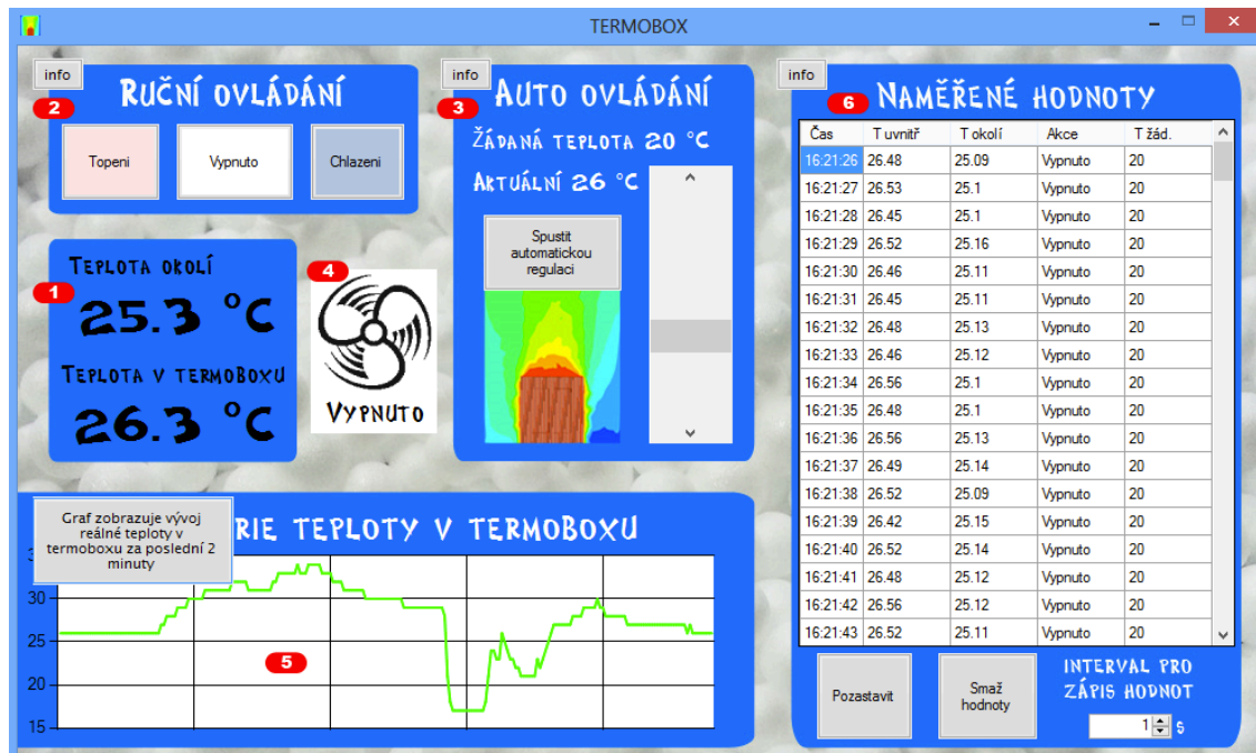
Obr. 31 Hlavní okno programu pro ovládání teploty v Termoboxu
