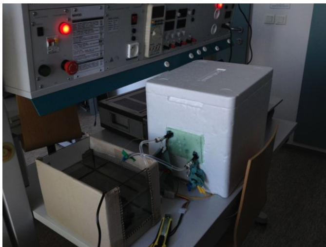
Obr. 22 Hotové řešení termoboxu včetně výměníku s chlazením
