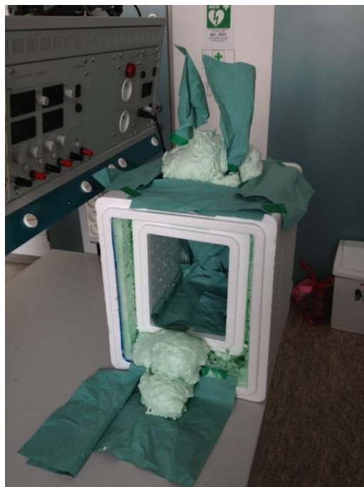
Obr. 21 Konstrukce komory - štríkání pur pěnou
