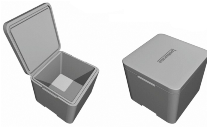
Obr. 4 3D model teplotního boxu z polystyrénu
