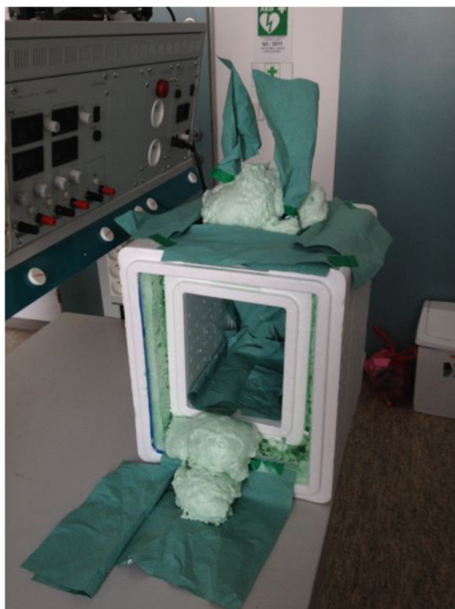
Obr. 21 Konstrukce komory - štříkání pur pěnou
