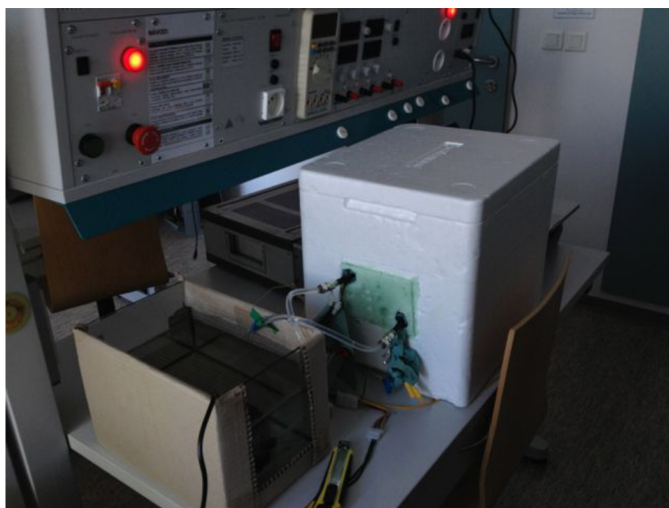
Obr. 22 Hotové řešení termoboxu včetně výměníku s chlazením
