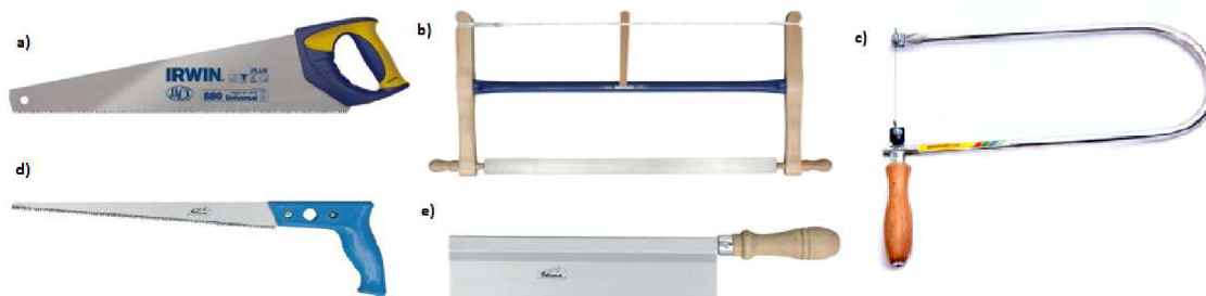
Obrázek 14: a) pila ocaska, b) rámová pila, c) lupénková pila, d) pila děrovka, e) pila čepovka (Zdroj: https://www.kutil.cz/vyber-naradi/nevylamte-si-zuby-pruvodce-svetem-rucnich-pil-na-drevo/ )
