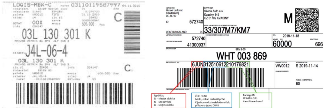
Obr. 3.15 C-závěska a GLT závěska používané pro příjem materiálu do skladu
