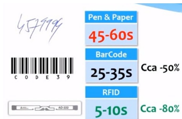
Obr. 5.6 Srovnání rychlosti čtení různých druhů identifikace
