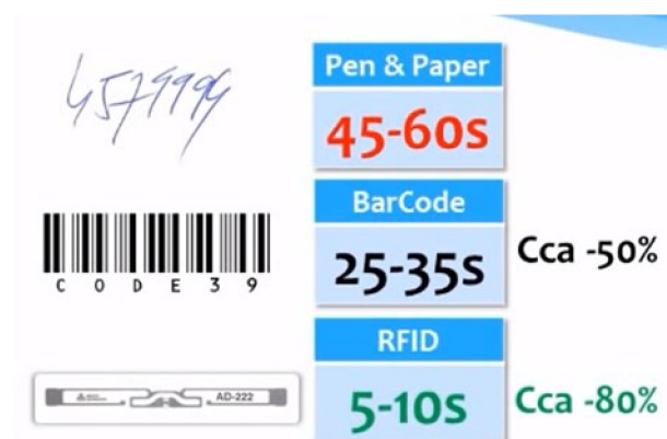
Obr. 5.6 Srovnání rychlosti čtení různých druhů identifikace
