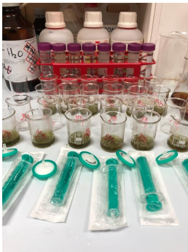
Obrázek 16: Filtrování vzorků pomocí filtru o velikosti 0,45 0,45 \mu\text{m} . Foto vlastní.
