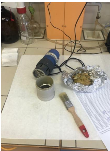
Obrázek 13: Po kvalitativním navážení vzorků salátu následovalo jejich rozemletí na automatickém ručním mlýnku téměř na prach. Foto vlastní.
