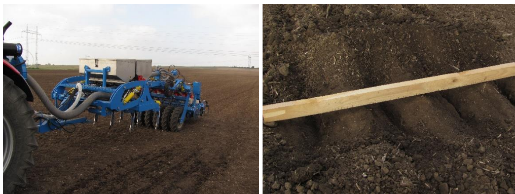
Obr. 4. Testovací modulový secí stroj firmy Farnet při zakládání porostů 3. 10. 2015 a odkrytá část půdy po odstranění nakypřené půdního profilu po zasetí na variantě 4 (kypření 180 mm). Foto Brant
