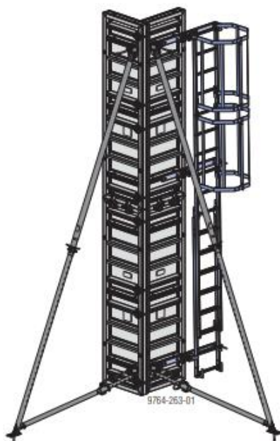
Obrázek 26: Sloupové bednění – první polovina [3]
