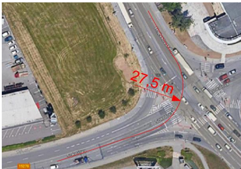
Obrázek 15: Trasa z půjčovny bednění – Kritický bod 2 [2]
