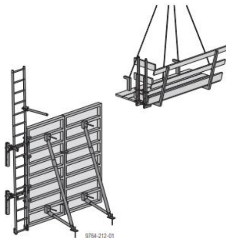
Obrázek 32: Rámové bednění – osazení betonářské plošiny [4]
