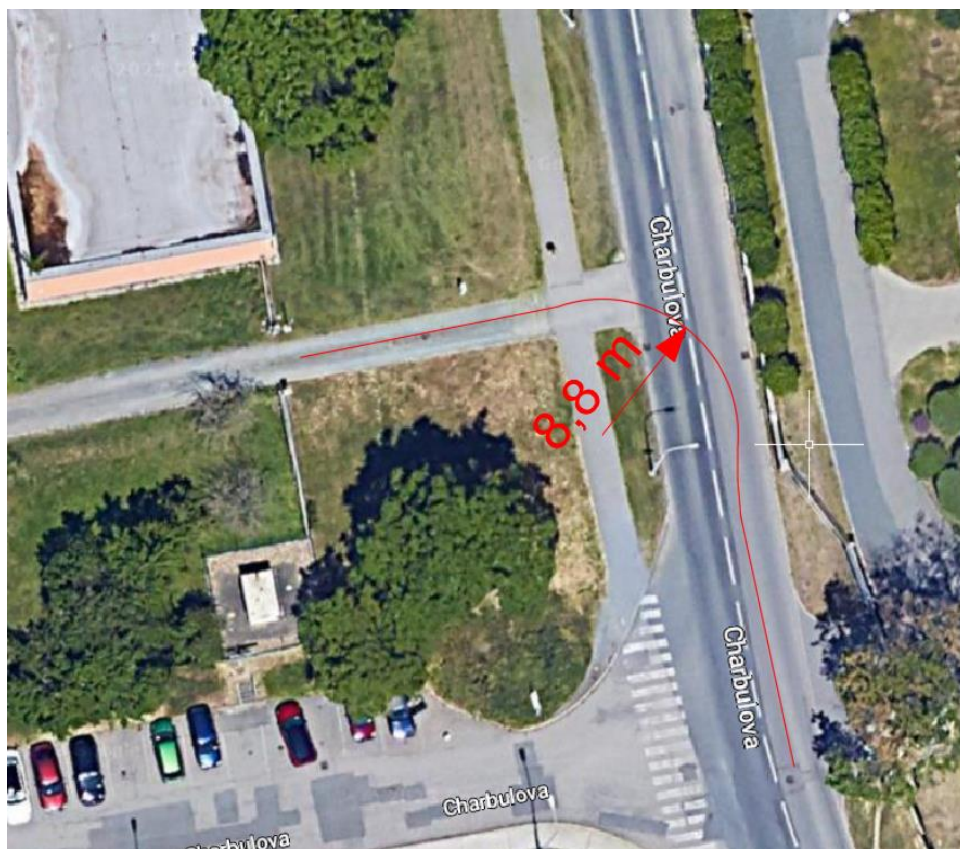
Obrázek 5: Trasa z betonárny – Kritický bod 3 [2]
