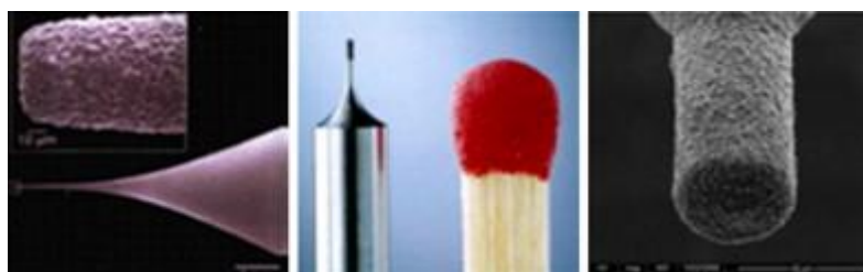
Obr. 12 Broušící nástroj „mikro-tužka“: CVD povlak, slinutý nástroj a galvanický povlak (zleva doprava) [13].
