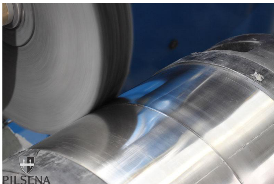
Obr. 30 Leštění válcové plochy pomocí leštícího kotouče [27].
