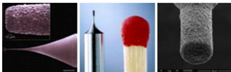
Obr. 12 Brousicí nástroj „mikro-tužka“: CVD povlak, slinutý nástroj a galvanický povlak (zleva doprava) [13].
