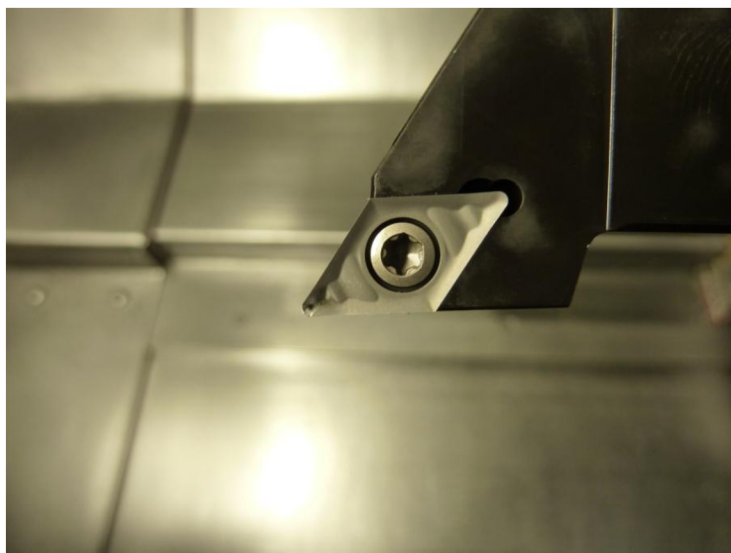
Obr. 41 Vyměnitelná břitová destička DCGX11T308-AI H10.
