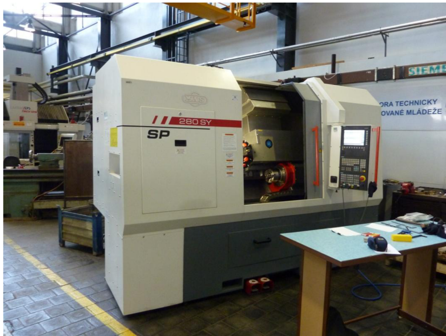
Obr. 43 CNS soustruh SP 280 SY.
