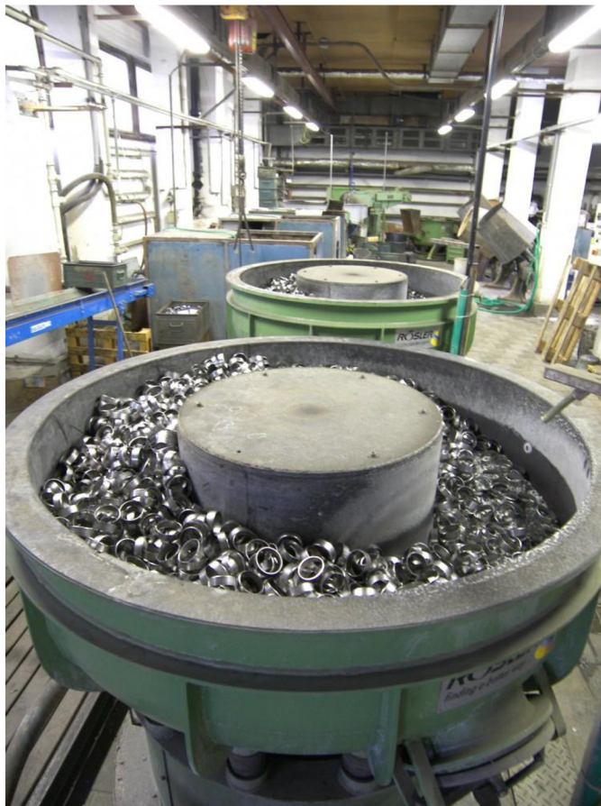
Obr. 33 Proces omílání v omílacím bubnu [31].
