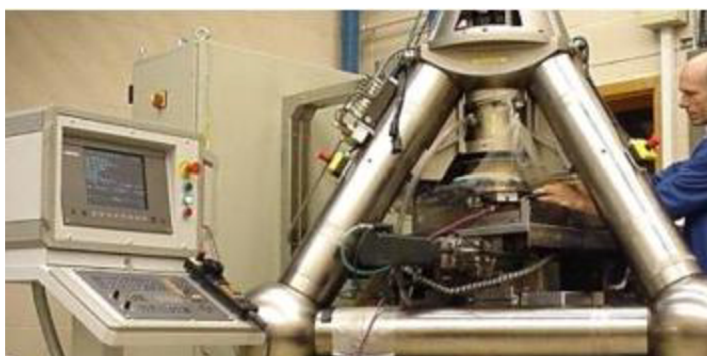
Obr. 10 Brousící stroj Tetraform C vyvinutý v NPL Tetraform [13].
