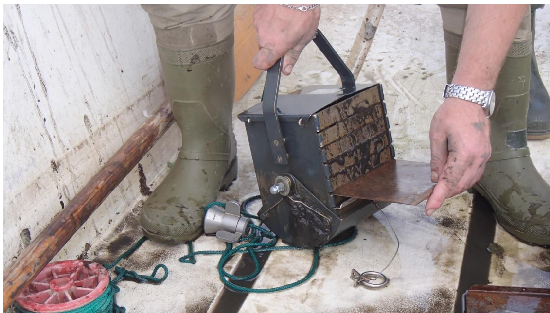
Obr. 3 Rozdělení jednotlivých vrstev sedimentu pomocí destiček.
