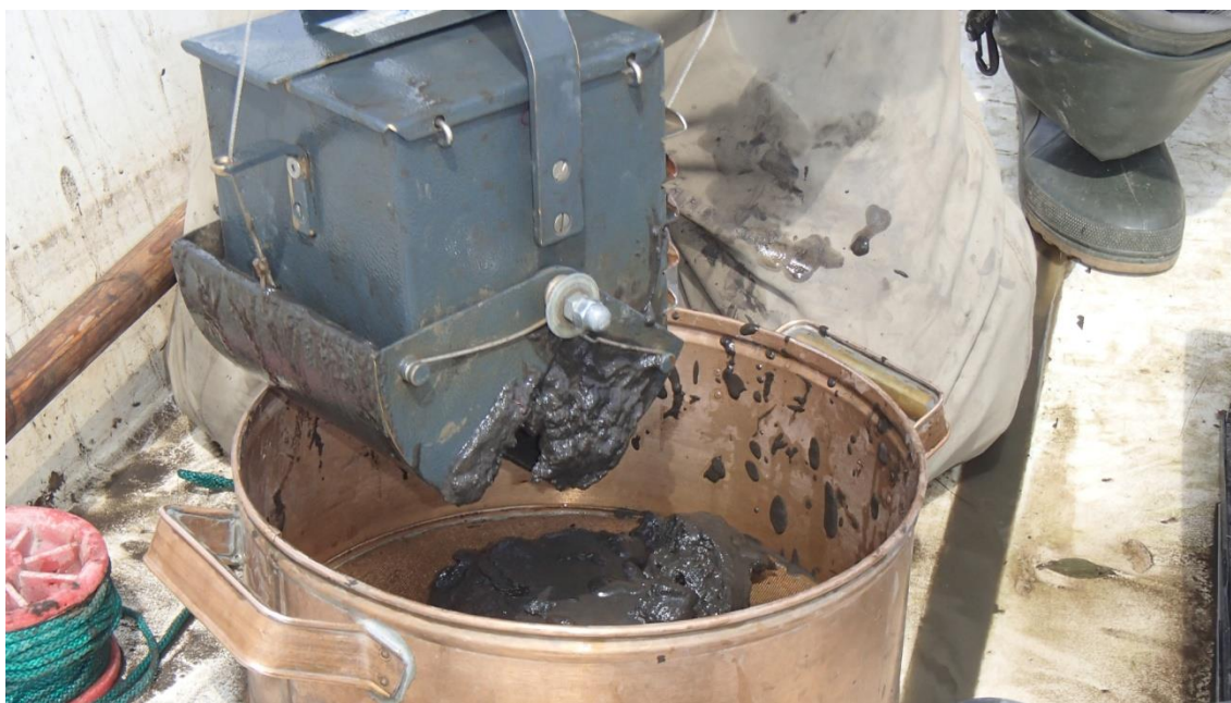
Obr. 4. Vyprazdňování sedimentu z drapáku na prosévací síto.
