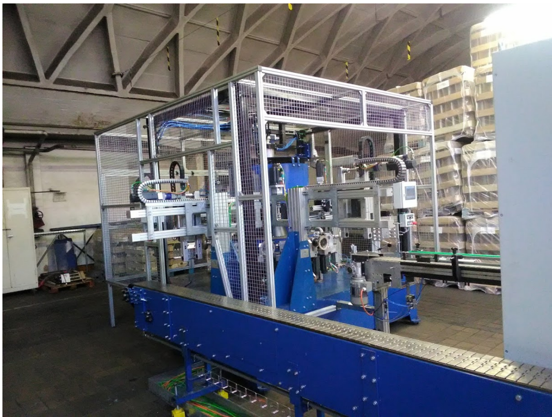
Obr. 7 Vyjímací destičkový dopravník. [Kavalierglass, a.s.]
