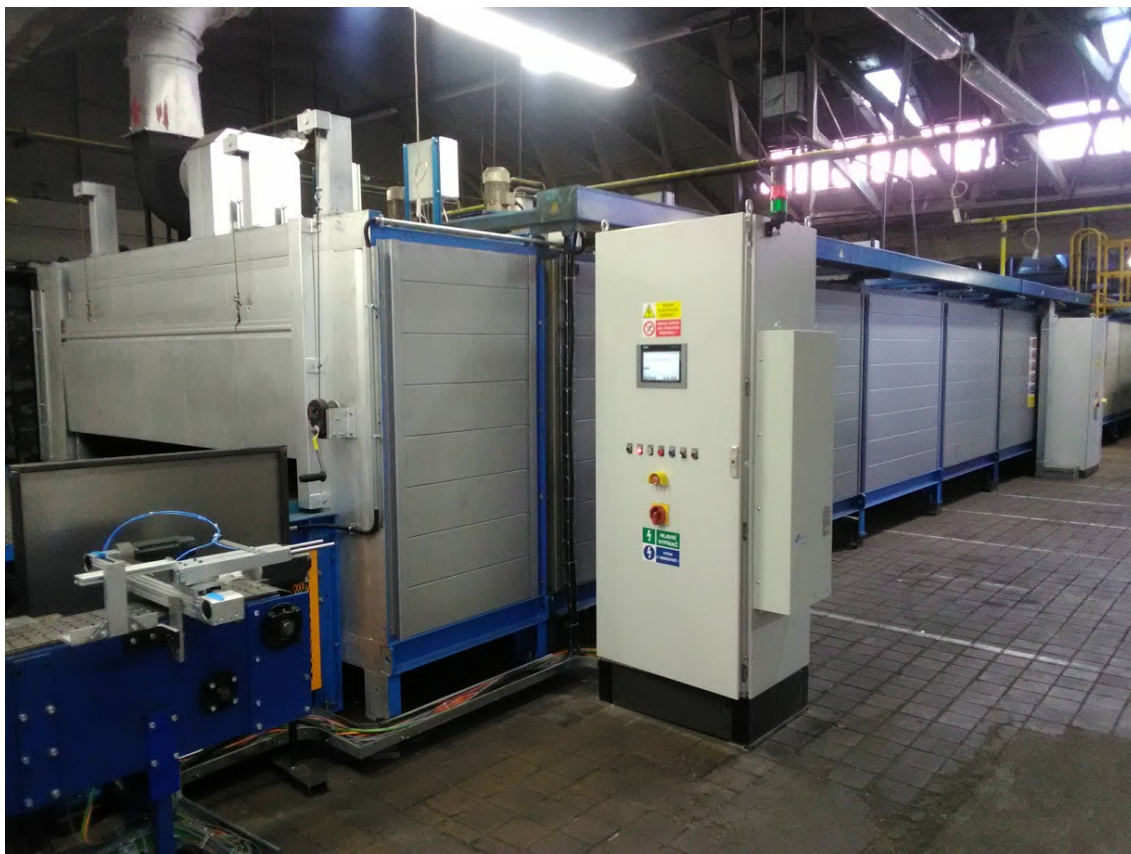
Obr. 9 Chladící pásová pec Carmet. [Kavalierglass, a.s.]
