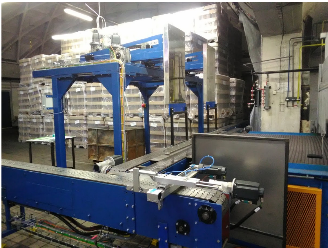
Obr. 8 Zakladač pásové pece. [Kavalierglass, a.s.]
