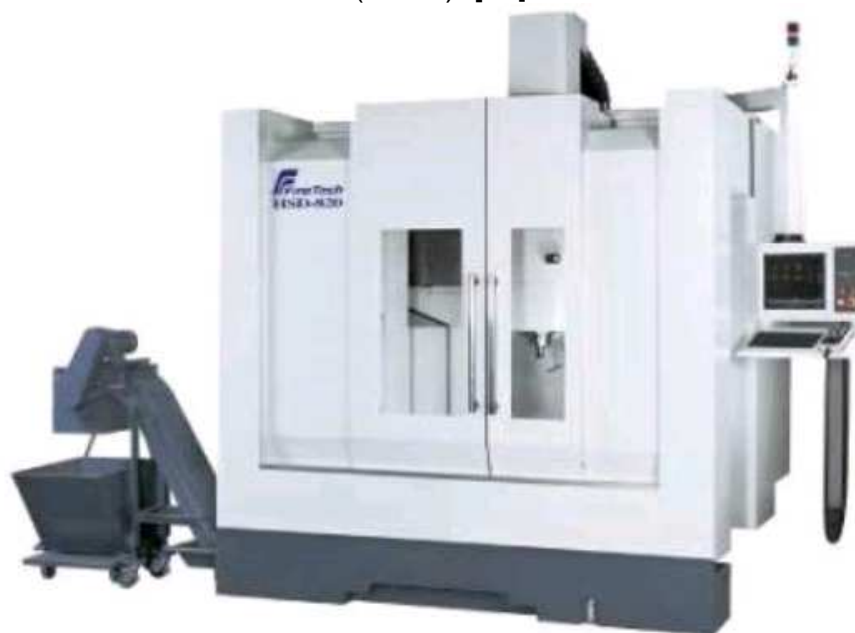
Obr. 5 Obráběcí centrum HSD 820 [22]
