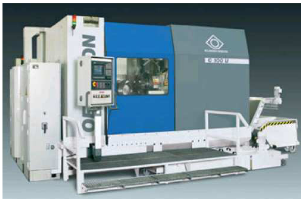
Obr. 38 Univerzální obráběcí stroj pro výrobu kuželových kol Oerlikon C 100 U [18]
