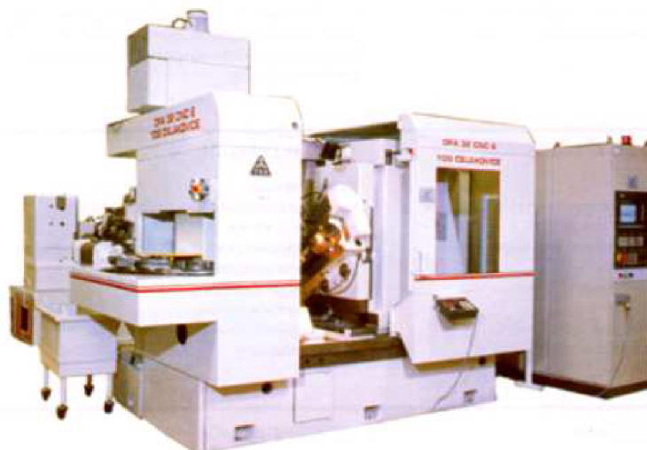
Obr. 36 Odvalovací frézka na ozubení OFA 32 CNC 6 [16]
