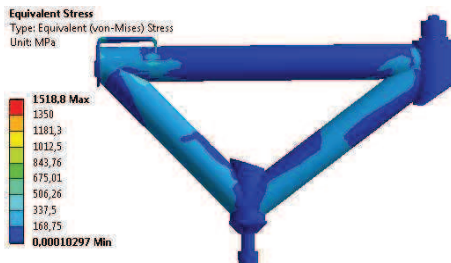
Obr. 15 Varianta 1 dle analýzy s redukovaným napětím von-Mises
