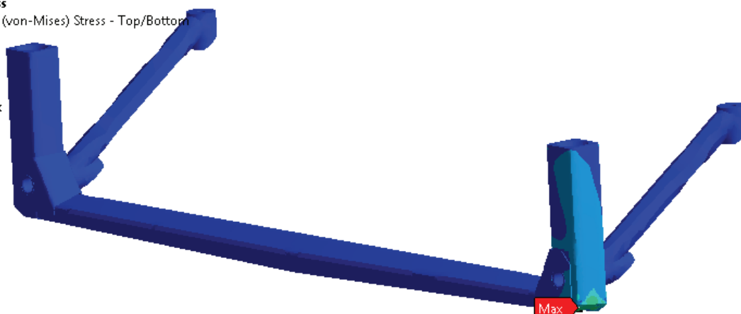
Obr. 26 Varianta 5 dle analýzy s redukovaným napětím von-Mises
