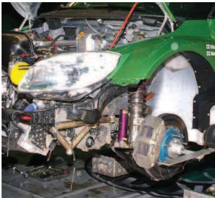
Obr. 3 Současný držák ližiny a jeho uchycení [5]
