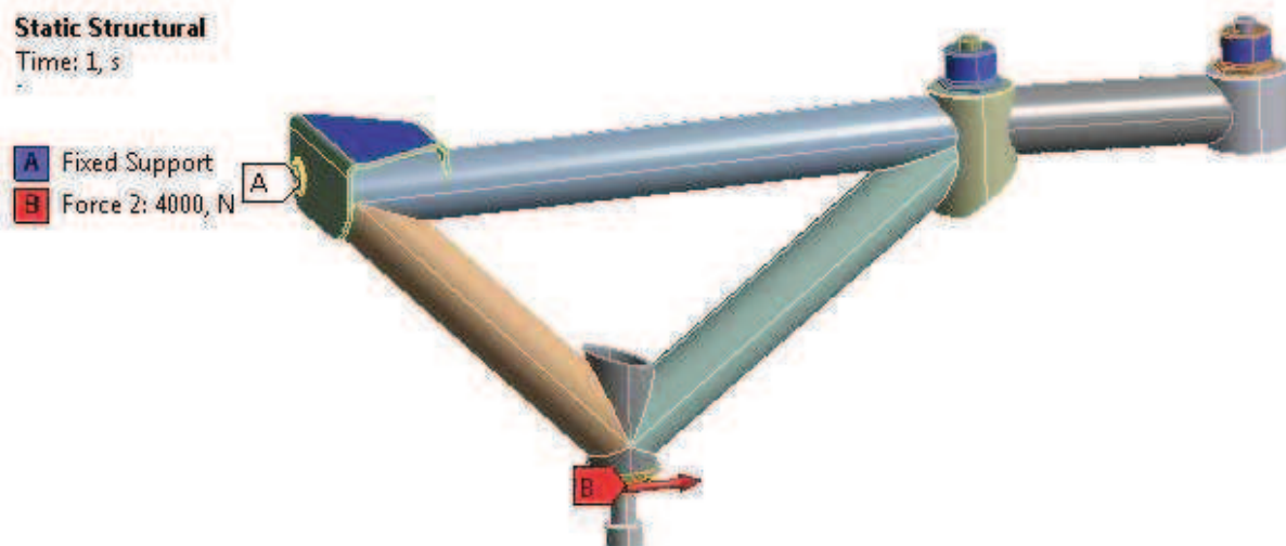
Obr. 9 Upevnění a síly pro analýzu při různých úhlech
