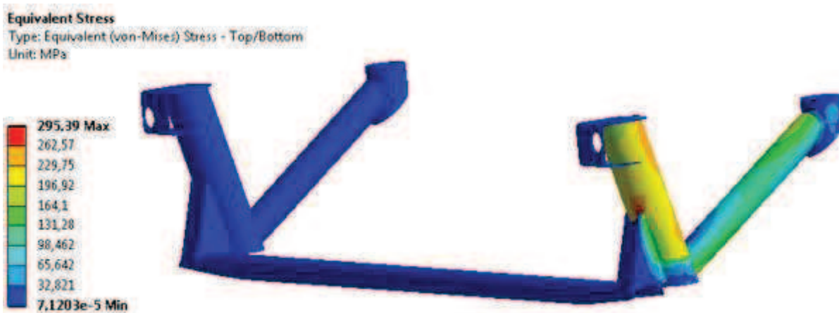
Obr. 40 Varianta 9 dle analýzy s redukováným napětím von-Mises
