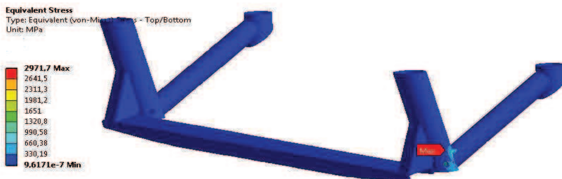
Obr. 30 Varianta 6 dle analýzy s redukovaným napětím von-Mises
