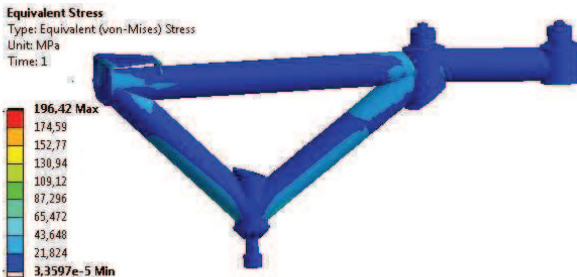
Obr. 10 Současná varianta dle analýzy s redukováným napětím von-Mises
