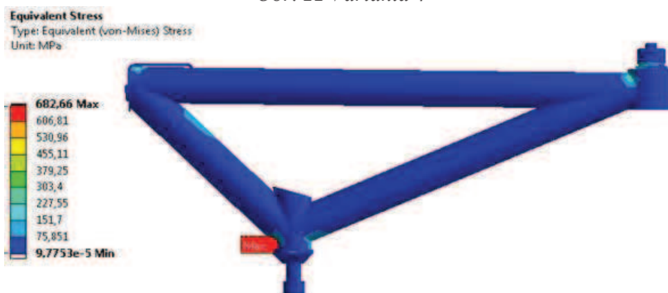
Obr. 23 Varianta 4 dle analýzy s redukováným napětím von-Mises
