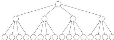
Obrázok 2.6: Stromová topológia - všetky častice sú usporiadané do stromu. Každá častica v takomto zapojení je ovplyvnená zatiaľ jej najlepšou pozíciou ( p_{Best} ) a najlepšou pozíciou častice, ktorá je v strome priamo nad ňou.
