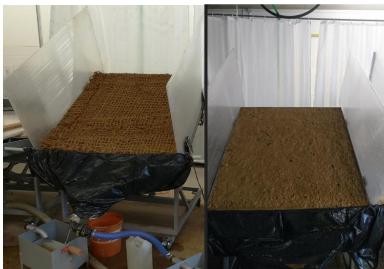
Obrázek 6- Svah pokrytý kokosovou sítí (vlevo), kontrolní svah (vpravo) po provedené sérii měření
