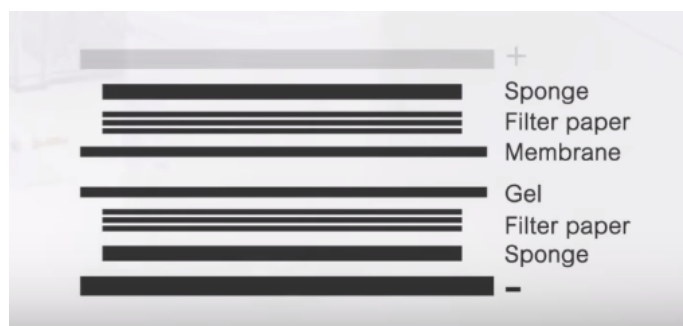
Obrázek 11: Obecné schéma vytvořeného „blotovacího sendviče“ (Bhandari, 2017).
