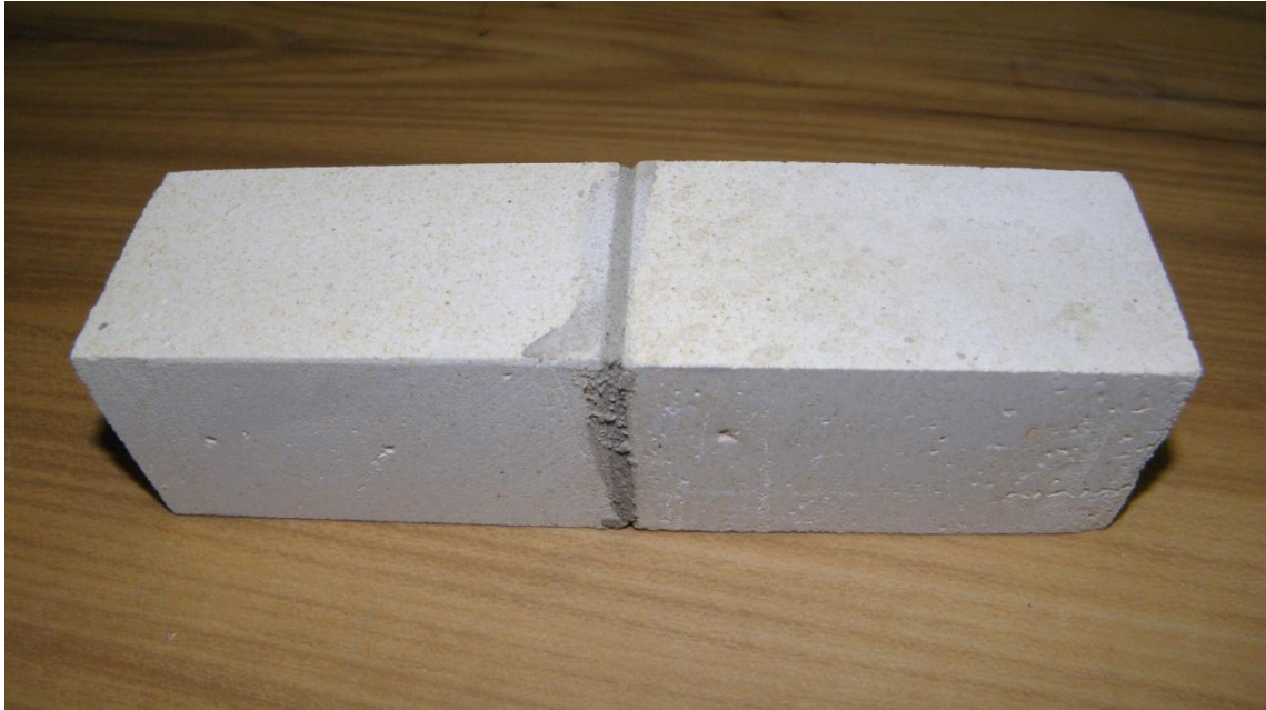
Obr. 6.2: Pevnost spoje v ohybu – zkušební těleso
