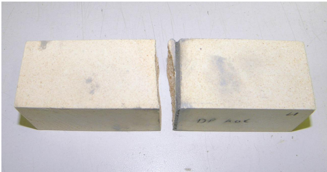
Obr. 7.1: Porušení zkušebního tělesa mimo tmel
