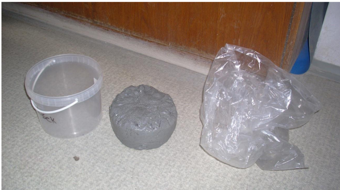
Obr. 8.2: stav tmelu NT 1350 po 4 týdnech
