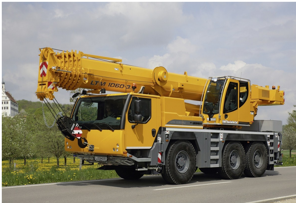
Obr. 3. 9 - Autojeřáb Liebherr LTM 1060-3.1
