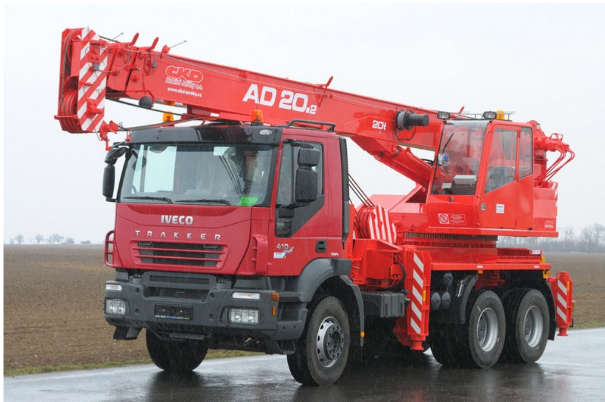
Obr. 3. 13 - Autojeřáb Iveco AD20
