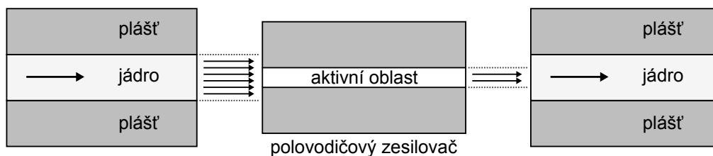
Obr. 6.13: Princip polovodičového optického zesilovače [4].
