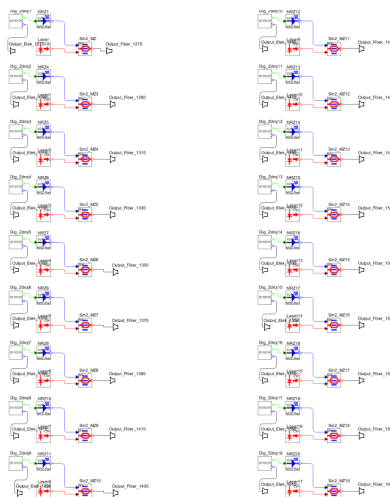
Obr. 7.14: Vnitřní zapojení CWDM vysílače.
