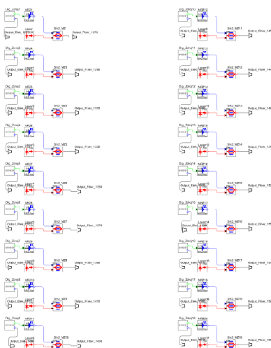
Obr. 7.14: Vnitřní zapojení CWDM vysílače.
