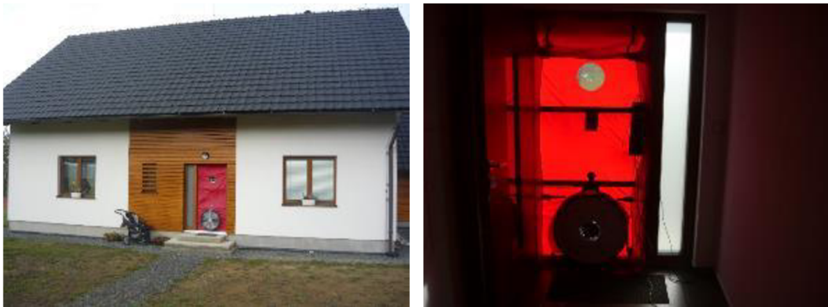
Obr. 5: Osazení měřícího zařízení (BLOWERDOOR) v měřené stavbě
