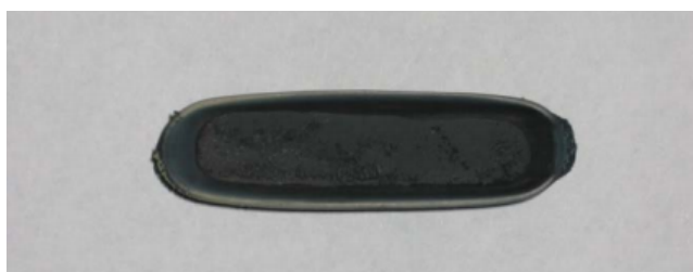
Obr. 3.5: Peleta po experimentu CVD [11]
