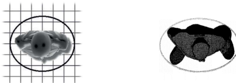
Obrázek 2: Levý obrázek je koncept uvedený do praxe Johnem J. Fruinem, plocha této elipsy těla je 0,22 \text{ m}^2 . [2] Pravý obrázek je elipsa těla dle Pheasantova konceptu. Průměrná plocha této elipsy je 0,20 \text{ m}^2 . [3]
