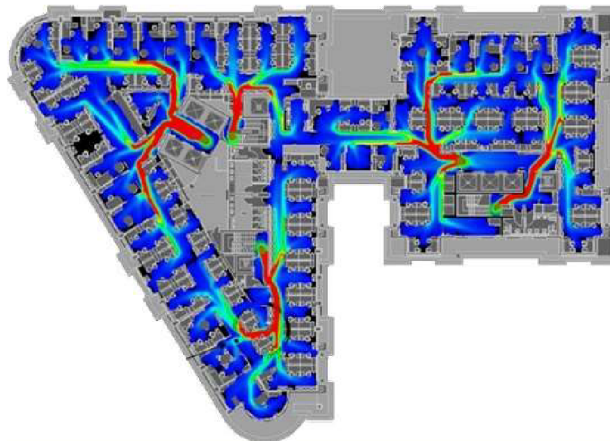
Obrázek 14: Typické pro makroskopický model je práce s celkem, a ne s jednotlivými osobami. Tento obrázek vyznačuje nejpoužívanější trasy v prostoru britského kampusu. [17]
