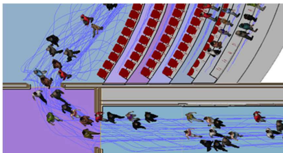
Obrázek 15: Mikroskopický model s jednotlivými osobami a jejich trajektoriemi. [18]
