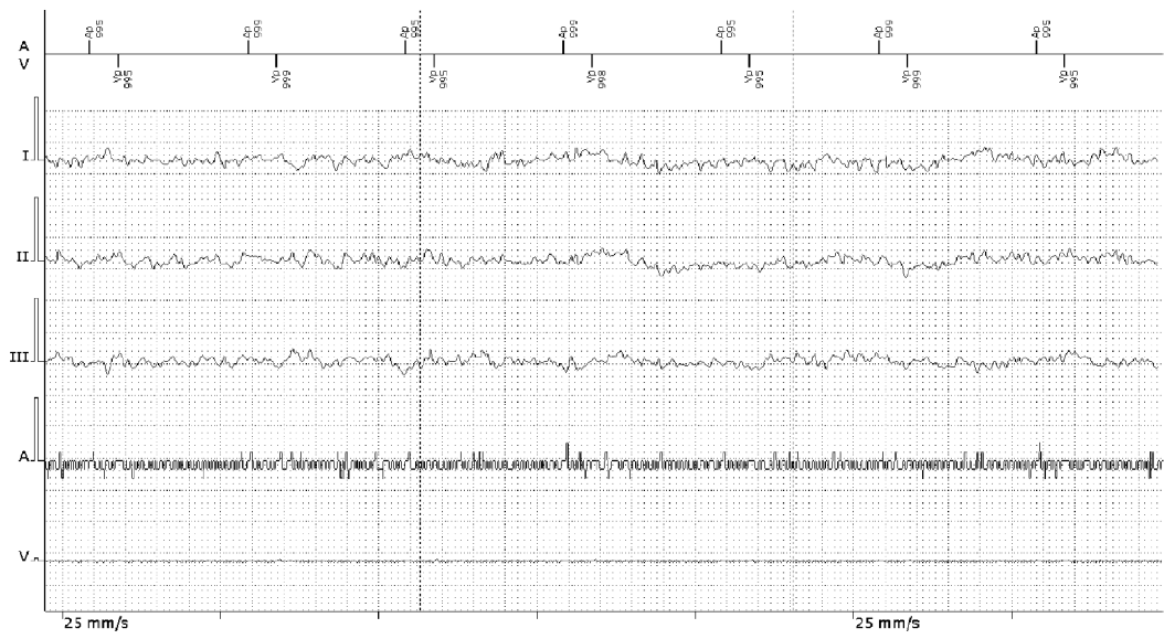
Obr. 8 Rušení při 30 Hz (zdroj: autor)
