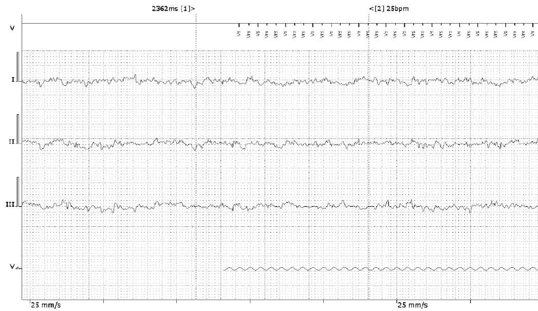
Obr. 2 Zarušení při 7 Hz (zdroj: autor)
