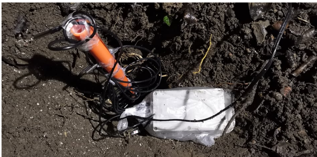
Obr. 2.4: Tyč se senzory uložena v zemi.
