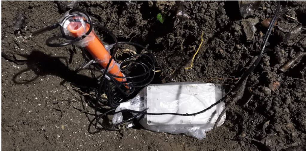
Obr. 2.4: Tyč se senzory uložena v zemi.
