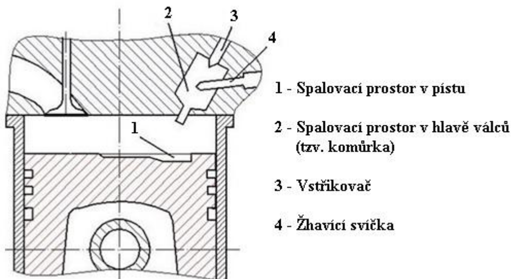
Obrázek 4 Dělený spalovací prostor; upraveno a převzato z [24]
