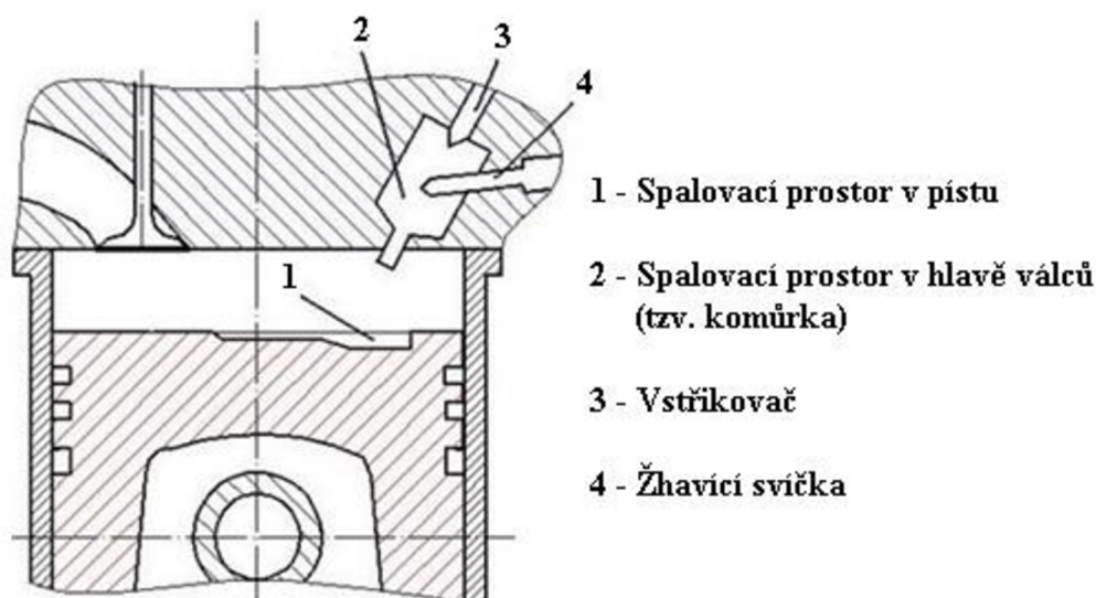
Obrázek 4 Dělený spalovací prostor; upraveno a převzato z [24]
