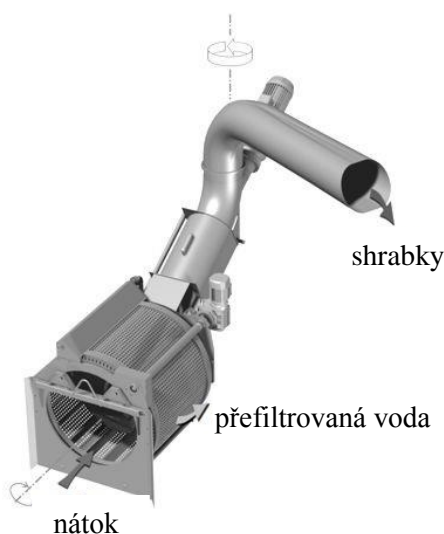
Obr. 10 Rotační česle [15]
