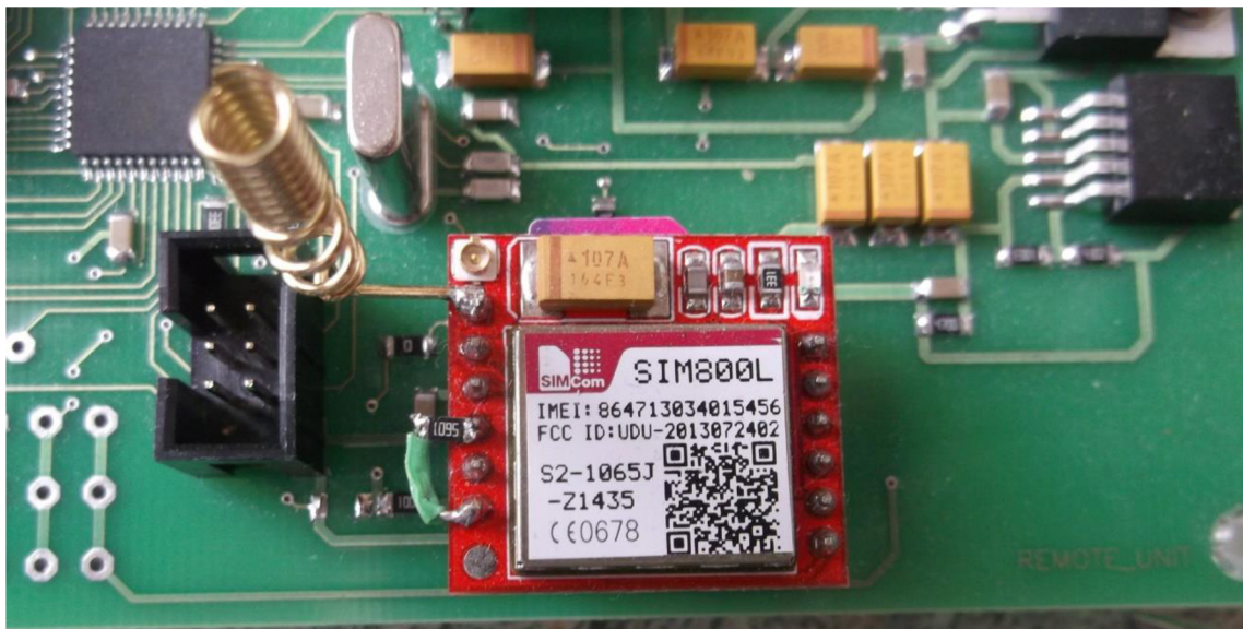
Obrázok 5:8 Oprava chyby napät'ového deliča
