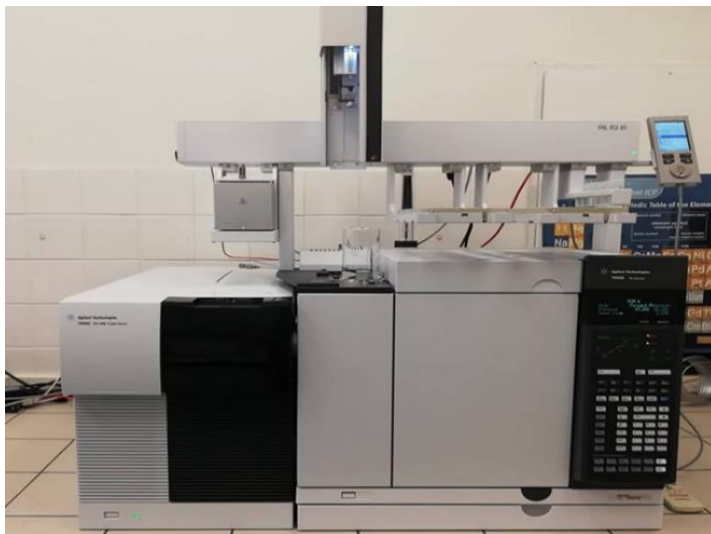
Obr. Plynový chromatograf s hmotnostní detekcí Agilent 7000D MS / 7890N GC (2018) použitý ke stanovení POPs v kalech (Foto: Košnář, 2024).
