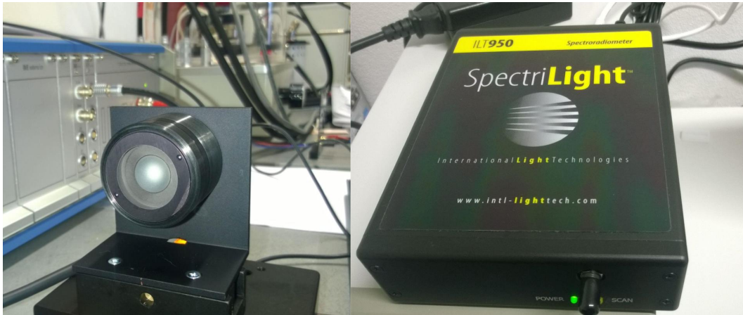
Obr. 8.6: Fotografie detektoru a analyzátoru pro systém CIMPS.
