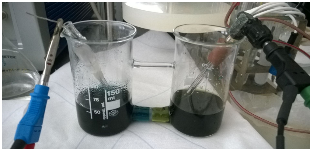
Obr. 10.1: Vanadový článěk v průběhu vybíjení při vlastním měření.
