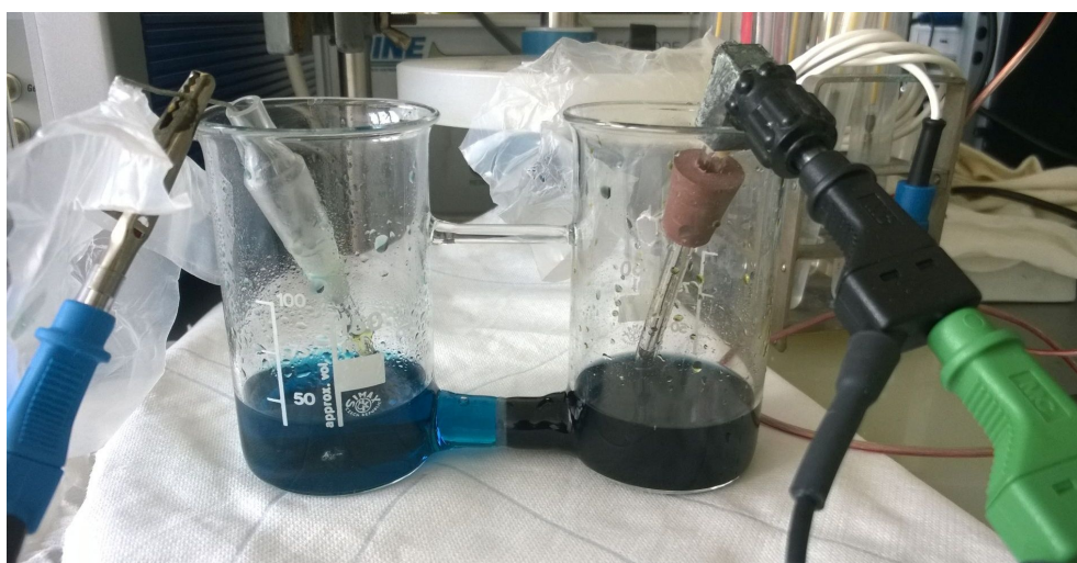
Obr. 10.4: Vybitý vanadový článek při druhém měření.
