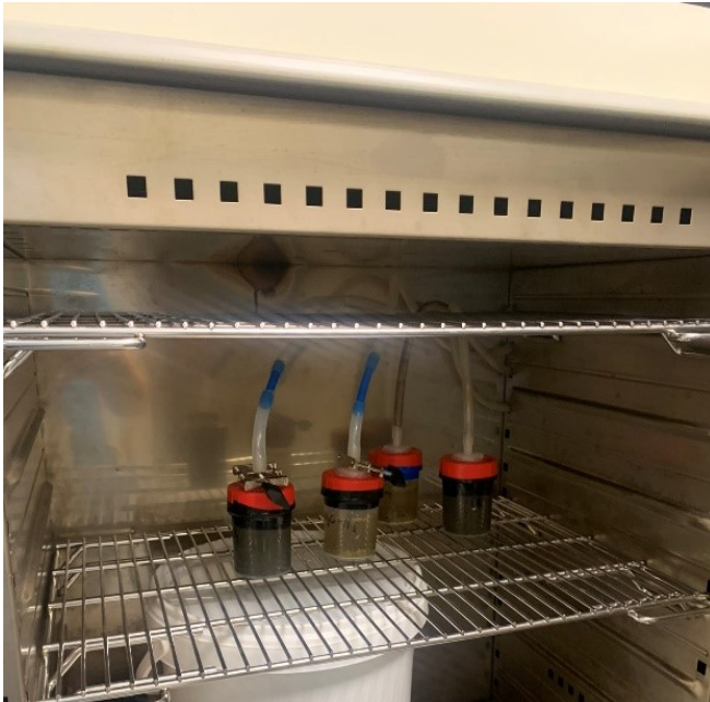
Obr. 8 Fermentory v peci (vlevo) s jímacím systémem (vpravo) při teplotě 50 °C
