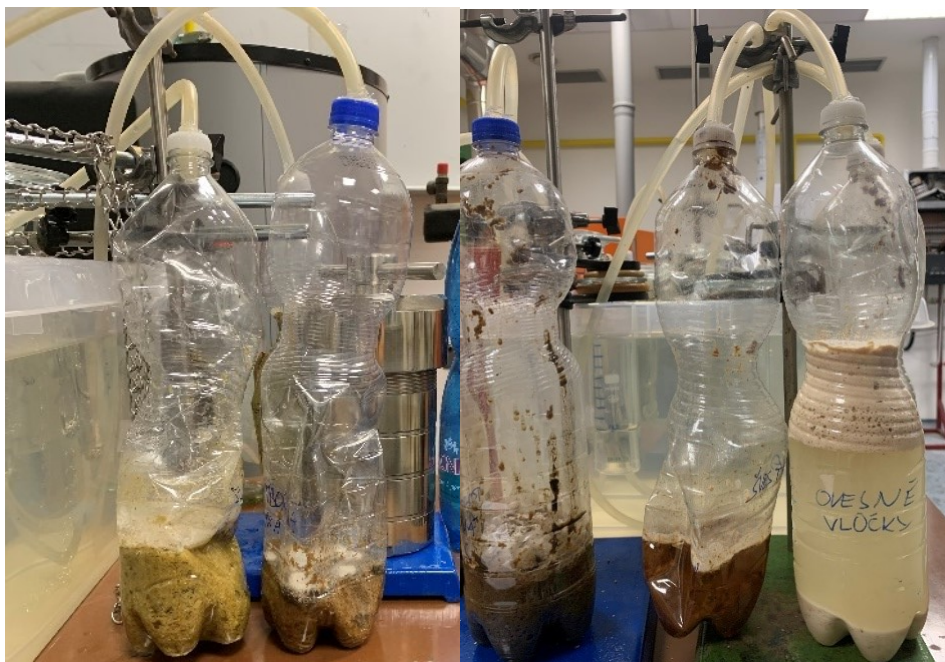
Obr. 6 Smrštěné a zevnitř plesnivé fermentory
