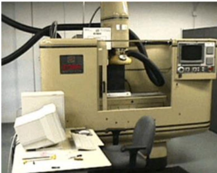
Obrázok 6: Deštruktívny skener RE 1000 [40]
