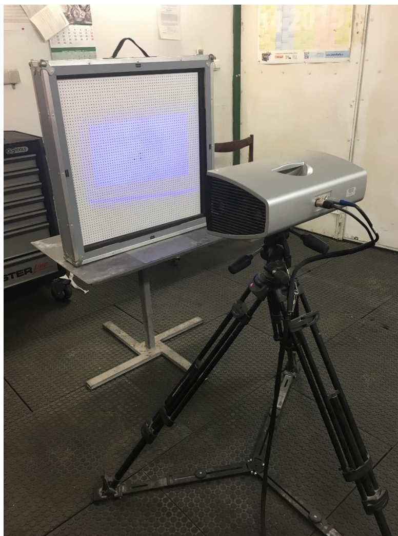
Obrázok 21: Správna poloha skenera voči kalibračnej doske
