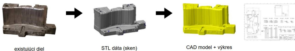
Obrázok 3: Proces reverzného inžinierstva [7]
