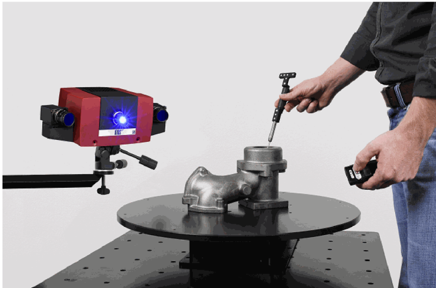
Obrázok 1: Skenovanie optickým skenerom Atos [38]
