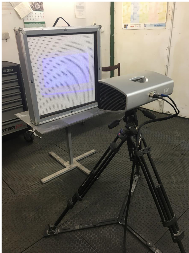
Obrázok 21: Správna poloha skenera voči kalibračnej doske
