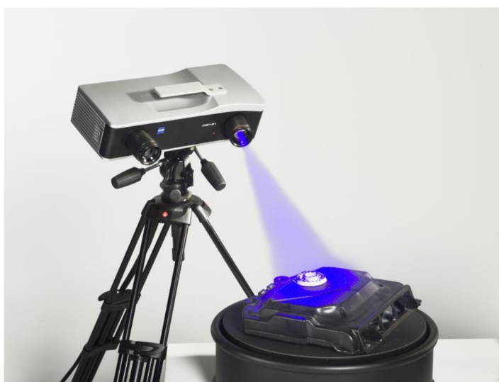
Obrázok 16: Optický skener STEINBICHLER COMET LED 5M [42]
