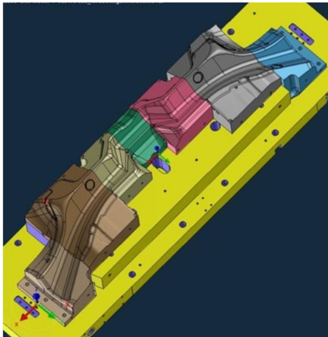
Obrázok 15: Zostava vložiek v nástroji [46]
