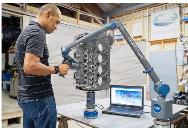
Obrázok 7: Mechanické meracie rameno FARO [41]
