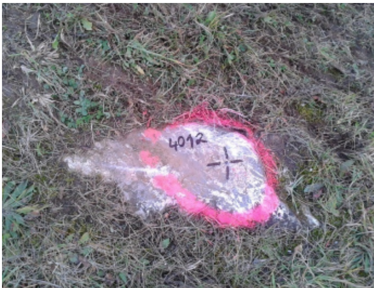
Obr. č. 10 : Stabilizácia vyrytím krížika do skaly
