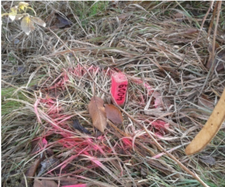
Obr. č. 9 : Stabilizácia kolíkom
