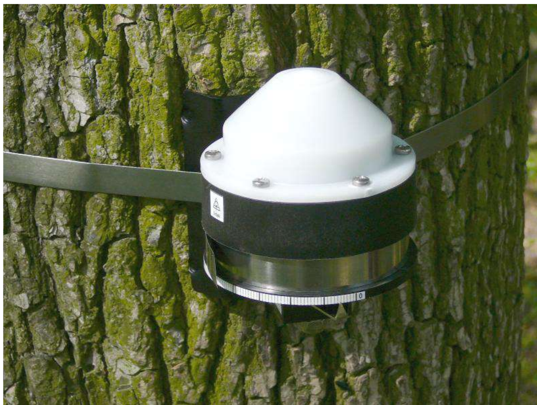
Obr. 6. Správná instalace dataloggeru (Kučera 2015)
