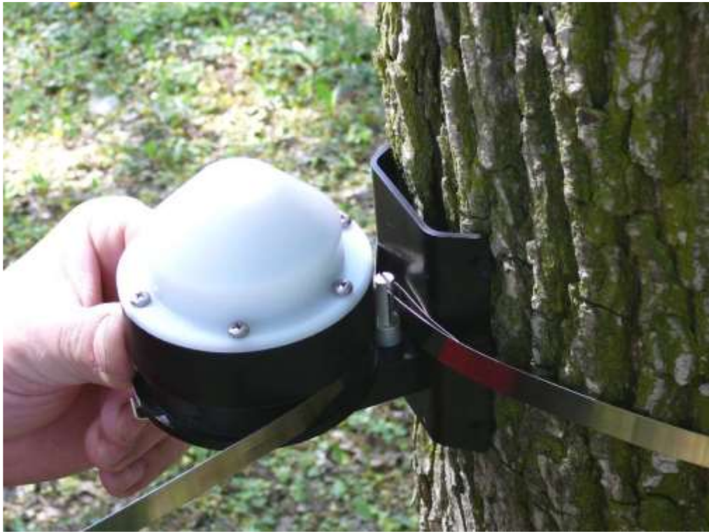
Obr. 4. Uchycení konce ocelového pásku, obtočení kmene a správné umístění na datalogger (Kučera 2015)
