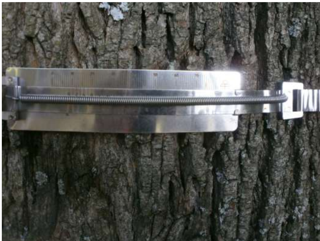
Obr. 7. Příklad nainstalovaného dendrometru. Dostupné z: http://soubory.debrujar.cz/2017/01/17/gallery/1556796452232949.jpg
