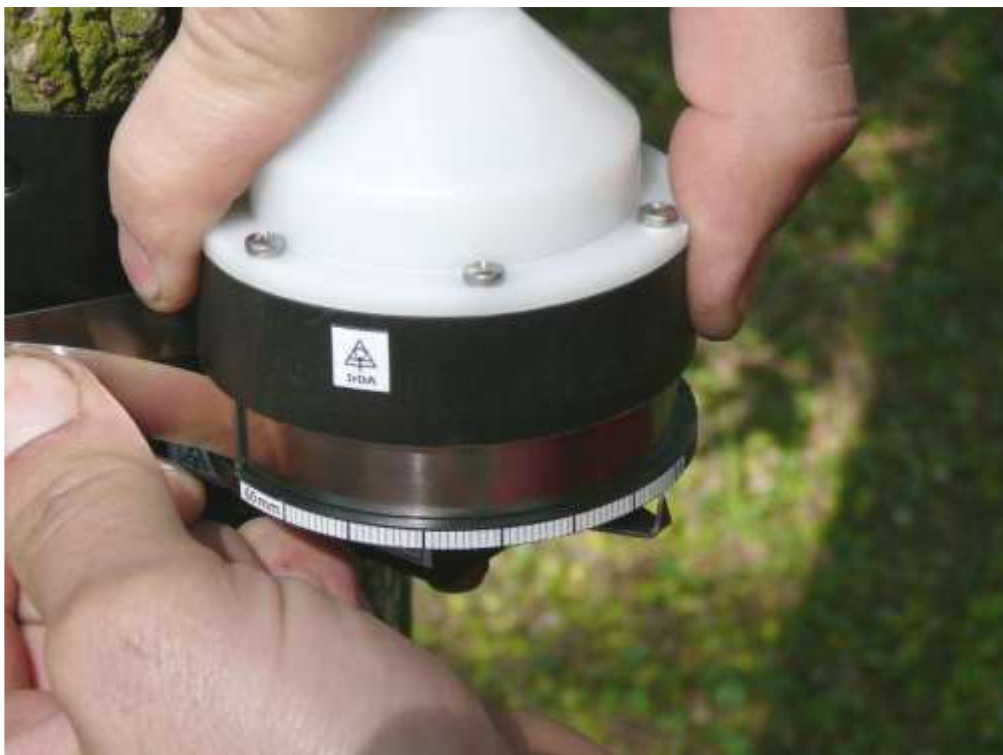
Obr. 5. Konečné uchycení ocelového pásku po natažení stupnice dataloggeru (Kučera 2015)
