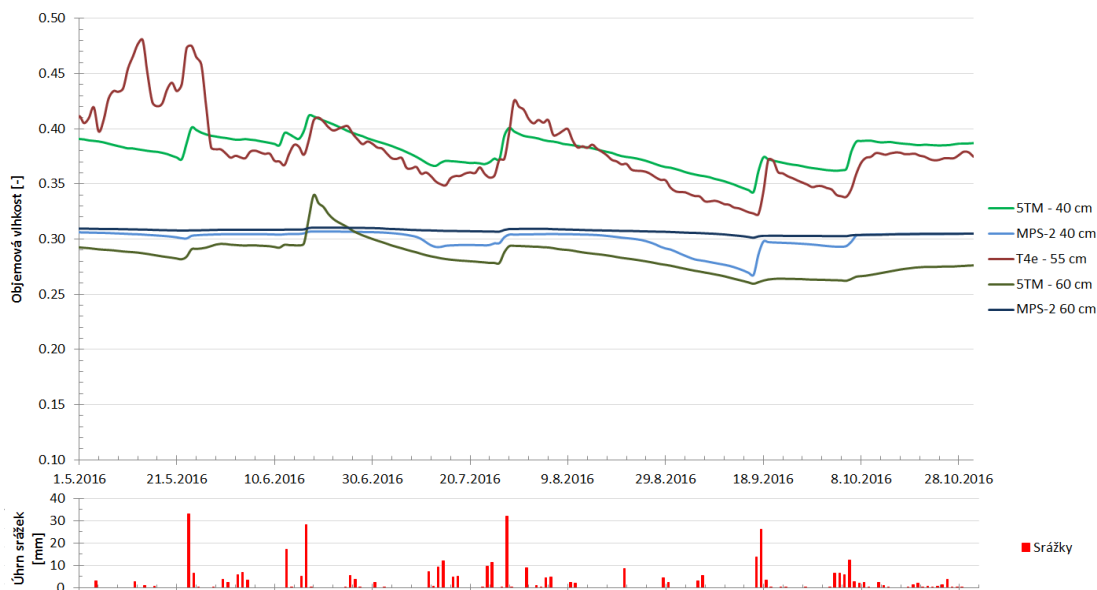
Obrázek 32. Grafické porovnání průběhu půdní vlhkosti v hloubce 40 – 60 cm
