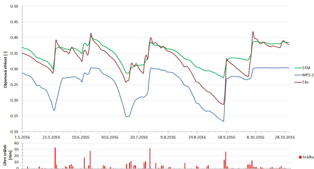
Obrázek 30. Grafické porovnání průběhu půdní vlhkosti v hloubce 20 - 30 cm
