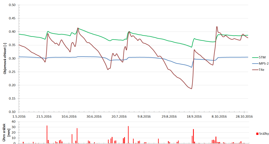
Obrázek 31. Grafické porovnání průběhu půdní vlhkosti v hloubce 30 - 40 cm
