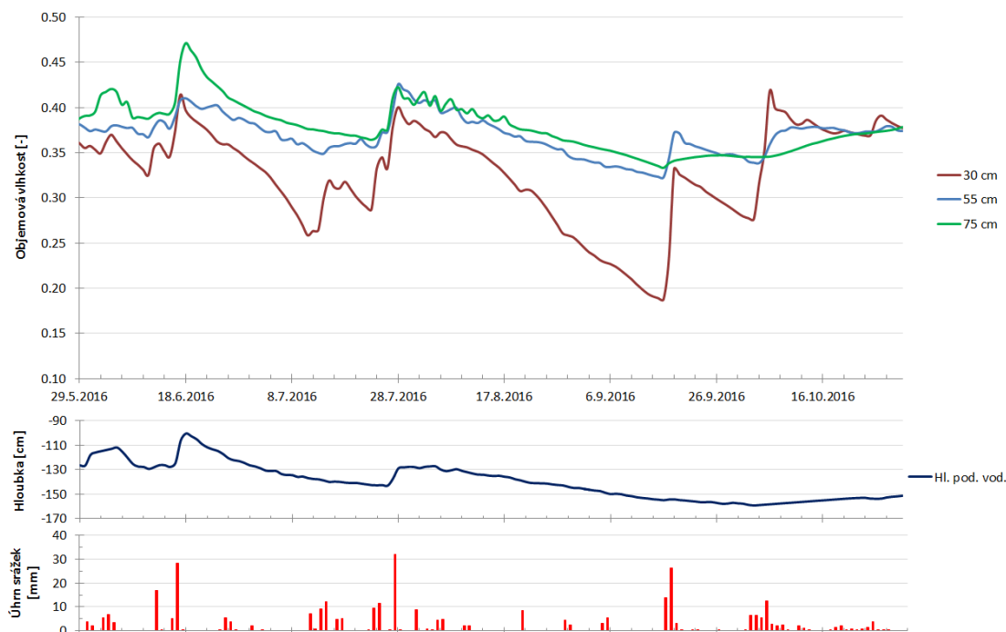
Obrázek 33. Změna vlhkosti půdního profilu v závislosti na úrovni hladiny podzemní vody měřené tenzometry T4e
