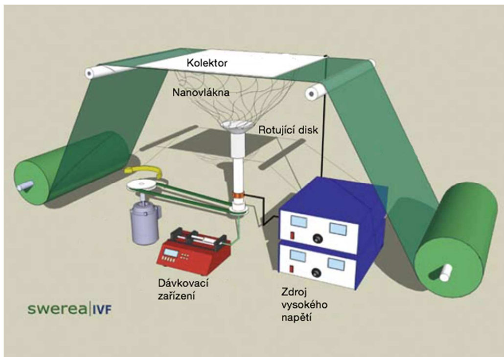
Obrázek 36: Schéma zařízení pro elektro - odstředivé zvlákňování. Převzato z [38].
