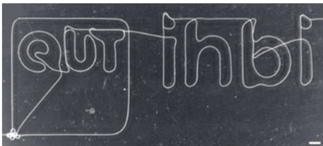
Obrázek 7: Vlákenná vrstva vytvořená metodou přímého psaní. Měřítka odpovídá 1 mm. Převzato z [14].
