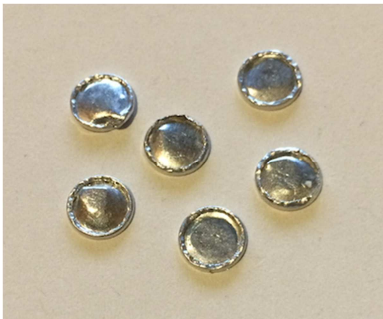
Obrázek 45: Vzorky připravené v hliníkové kapsli pro diferenciální skenovací kalorimetrii (DSC).
