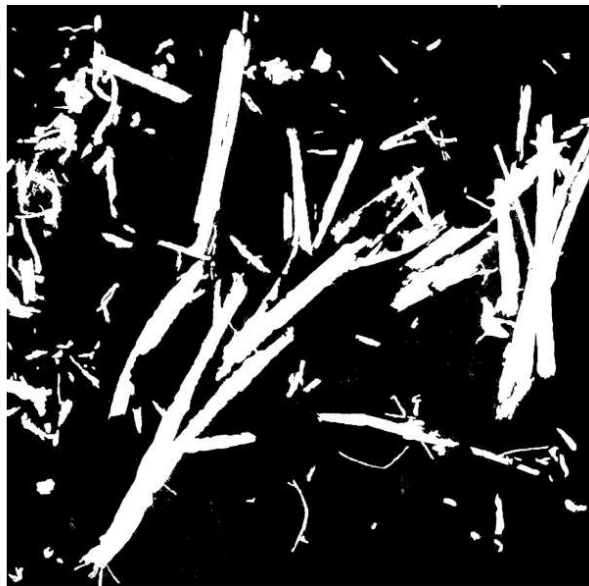
Pořízená a zpracovaná fotografie pokrývnosti posklizňovými zbytky u stroje HORSCH Tiger 5 MT při prvním měření
