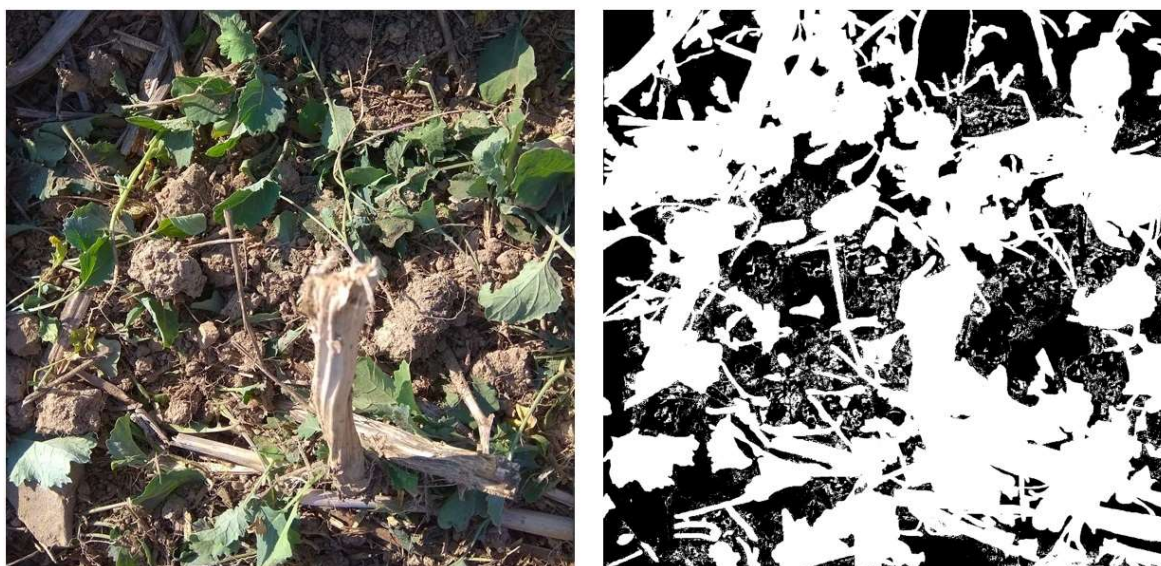
Obrázek 16: Pořízená a zpracovaná fotografie pokryvnosti posklizňovými zbytky u stroje HORSCH Terrano 5 FM při druhém měření
