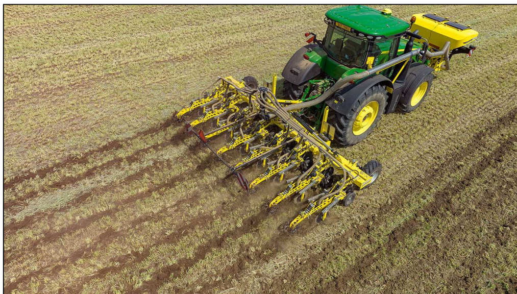
Obrázek 6: Řádkový kypřič pro pásové zpracování půdy STRIP-MASTER EN
