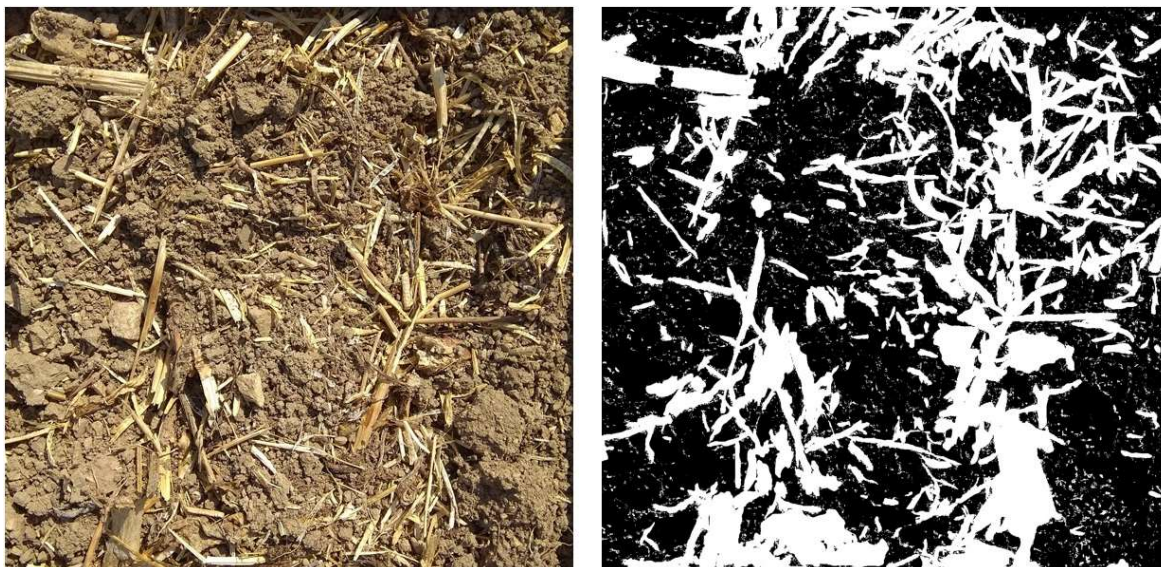
Obrázek 15: Pořízená a zpracovaná fotografie pokryvnosti posklizňovými zbytky u stroje VÄDERSTAD Carrier 626 XL při prvním měření
