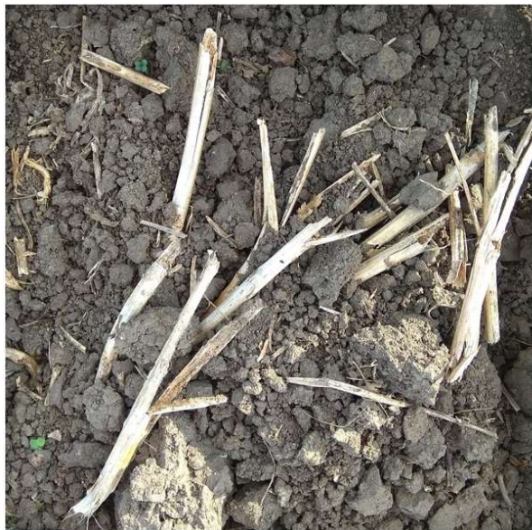
Pořízená a zpracovaná fotografie pokrývnosti posklizňovými zbytky u stroje HORSCH Tiger 5 MT při prvním měření
