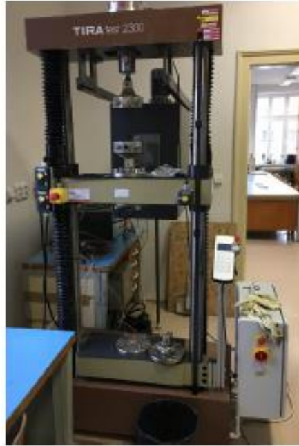
Obr. 25 – Příklad TIRA test 2300 pro měření pevnosti materiálu [31]
