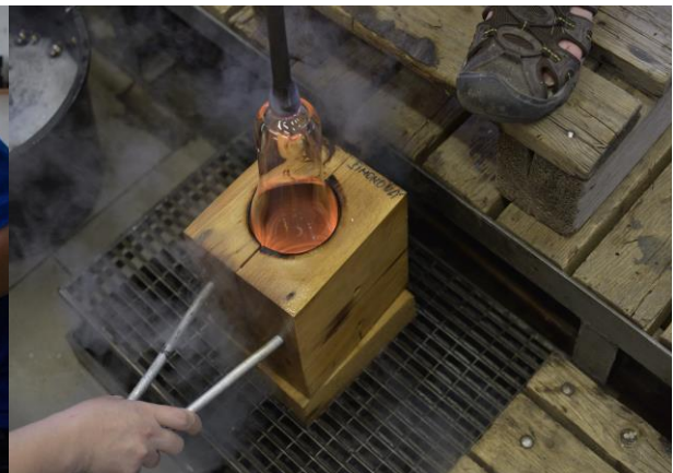
Obrázok 21 Fúkanie skla do formy [21]
